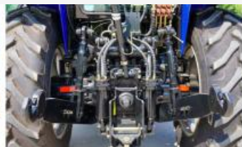
Levage et abaissement puissants, trois sorties hydrauliques
