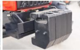
Contrepoids avant et arrière 44/40 kg
